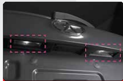
این چراغ برای آنکه پلاک راهنمایی و رانندگی به وضوح دیده شود به کار می‌رود.
